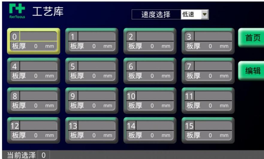
速度选择：点击切换速度，“高速”、“中速”、“低速”三种可选，每种速度各对应 16 种工艺参数；
