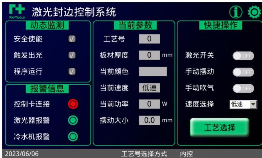
激光封边控制系统主界面分为动态监测、报警信息、当前参数、快捷操作四个功能模块。
