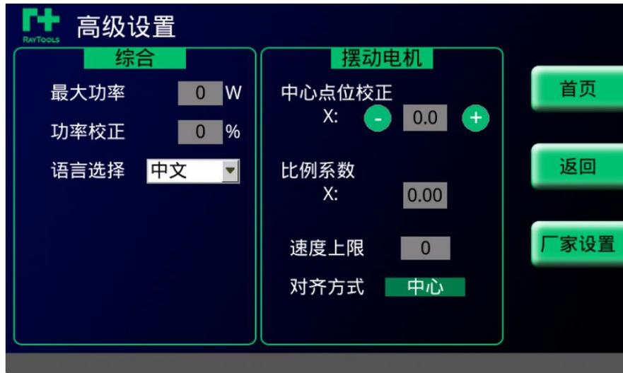
最大功率：对应设置为激光器最大功率，此处参数与激光器实际参数不匹配会导致实际出光功率与设置值有偏差；
